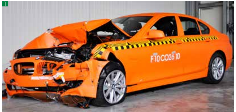
1 Dommages sur le véhicule ayant subi la collision à 64 km/h.
