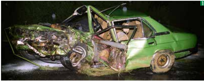
1 Habitacle de la BMW presque entièrement enfoncé au niveau du siège du conducteur, colonne de direction redressée et rentrée à l'intérieur.
