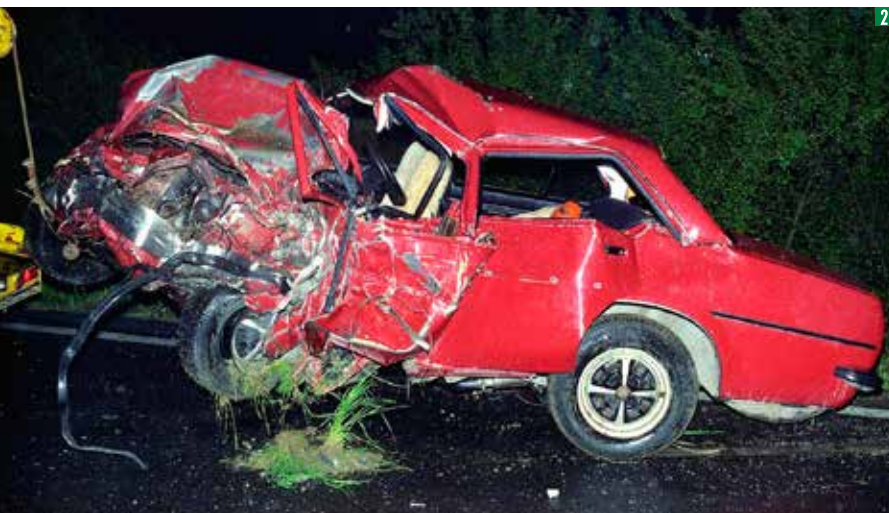
5 Avant du véhicule déformé vers la gauche.
